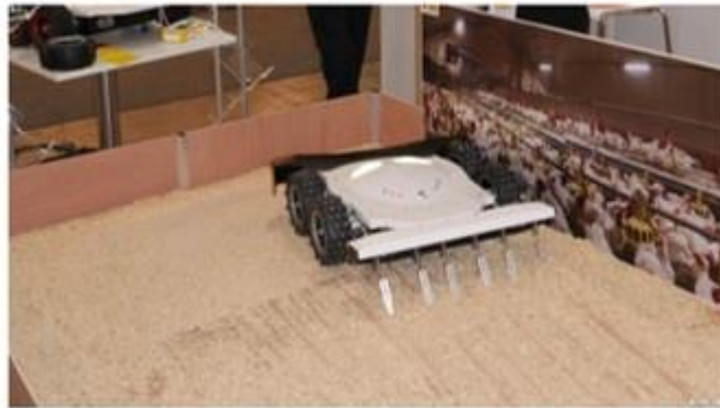
Roboter "Curiosity" fährt autonom durch den Hühnerstall und lockert das Einstreu auf. Das soll sich positiv auf die Tiergesundheit und die Umweltwerte des Stalls auswirken.
