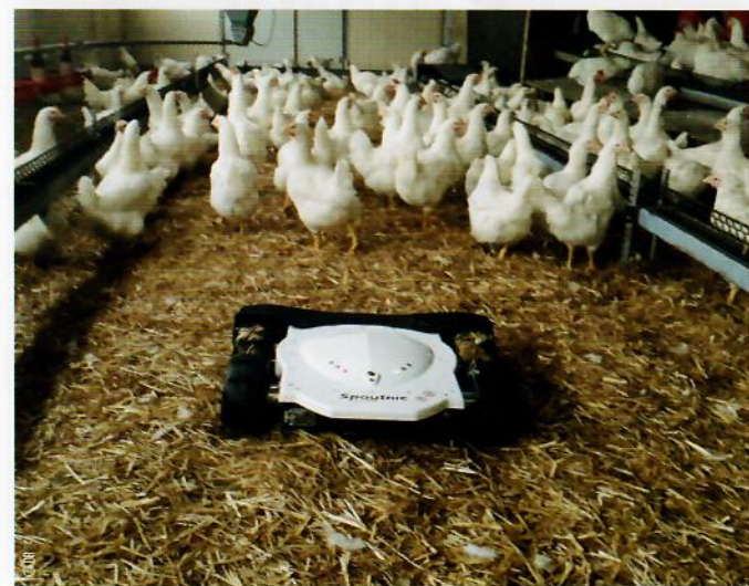
Le robot Spoutnic NAV a deux avantages principaux pour la production de poulet de chair : il stimule le mouvement des oiseaux et aère la litière.
